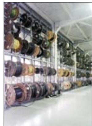
DEPOZITARE PENTRU COLACI DE CABLU
