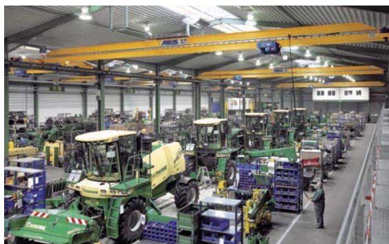
Poduri rulante monogrindă cu electropalane cu cablu, comandate în tandem ABUS ELK amplasate într-o fabrică de asamblare mașini agricole
