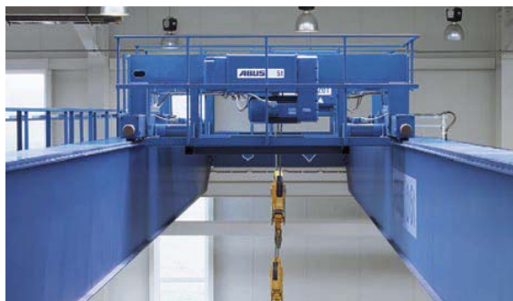
La electropalanul ABUS D, platforma circulabilă asigură accesul comod
