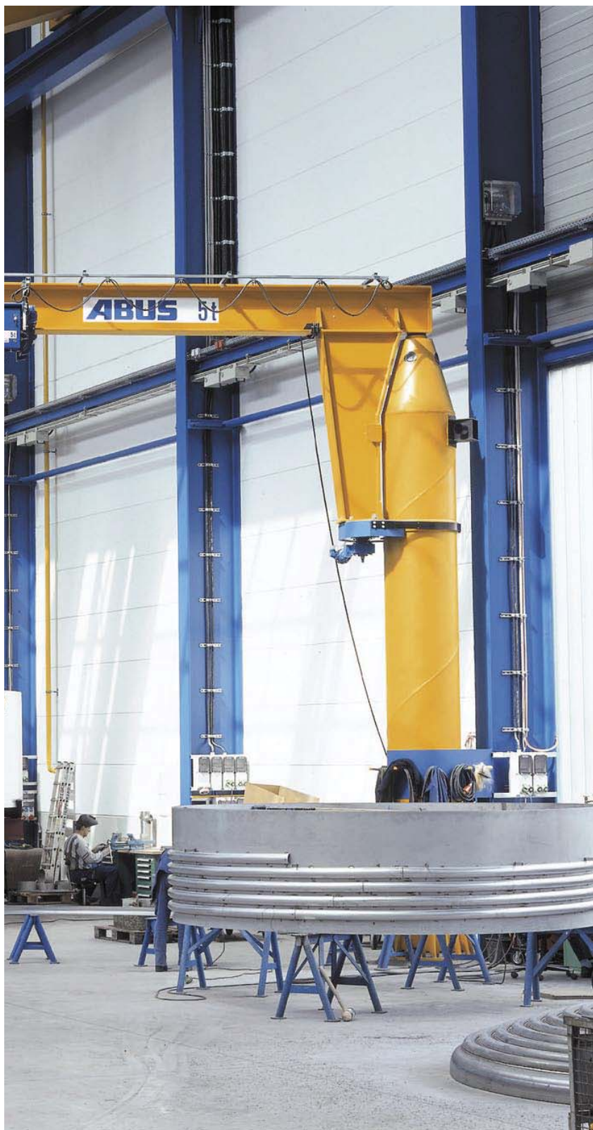
Macara pivotantă cu coloană ABUS VS cu acționare electrică, utilizat la fabricarea cazanelor
