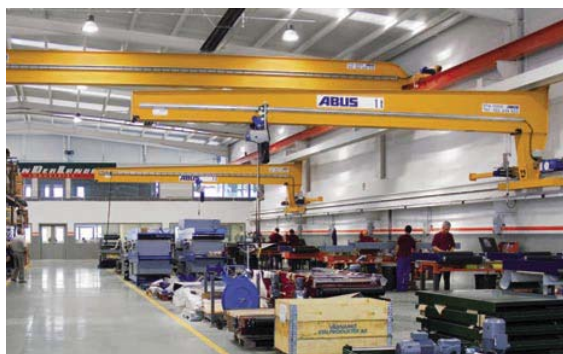
Pod rulant monogrindă în consolă ABUS EKL, utilizat la transportul diverselor materiale
