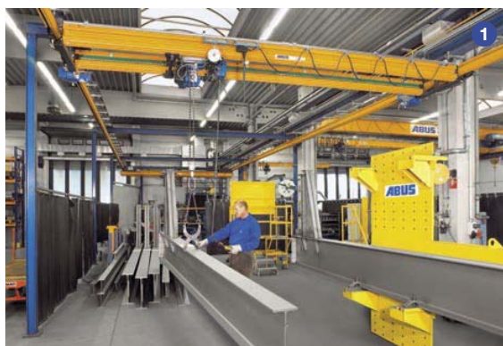
Sistemul ABUS ZHB cu două căi de rulare, ușurează transportul europrofililor lungi
