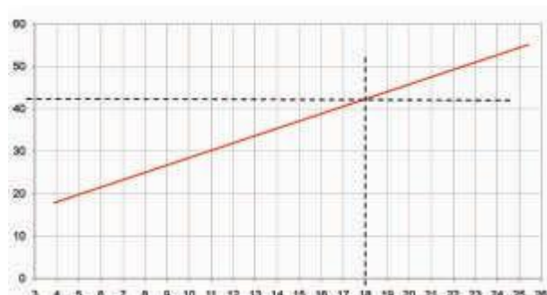
Graficul 1.3 Pentru aceeași înălțime de 43mm, un receptor cu diametrul de scurgere de 75mm poate prelua un debit de 18l/s.
