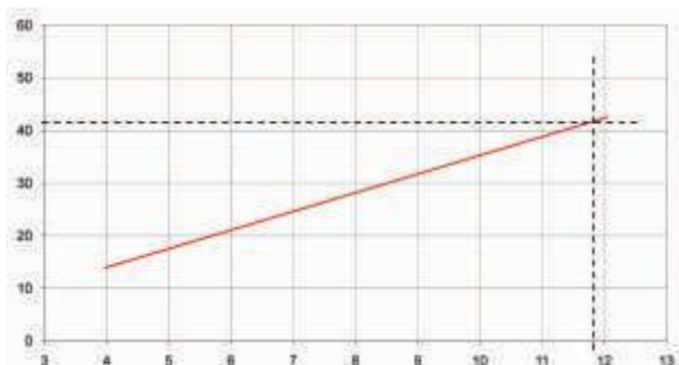
Graficul 1.2 Un receptor de terasă cu un diametru de scurgere de 50mm poate prelua un debit de 12l/s pentru un nivel al apei de 43mm.
