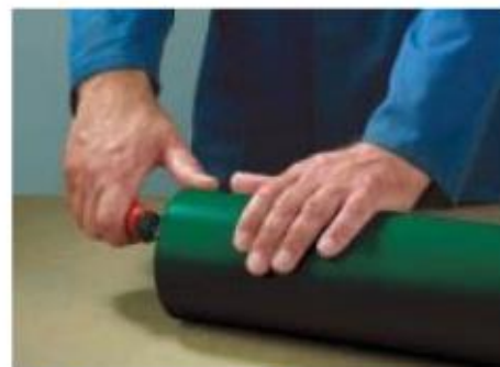
3. Debavurați muchia exterioară a conductei
